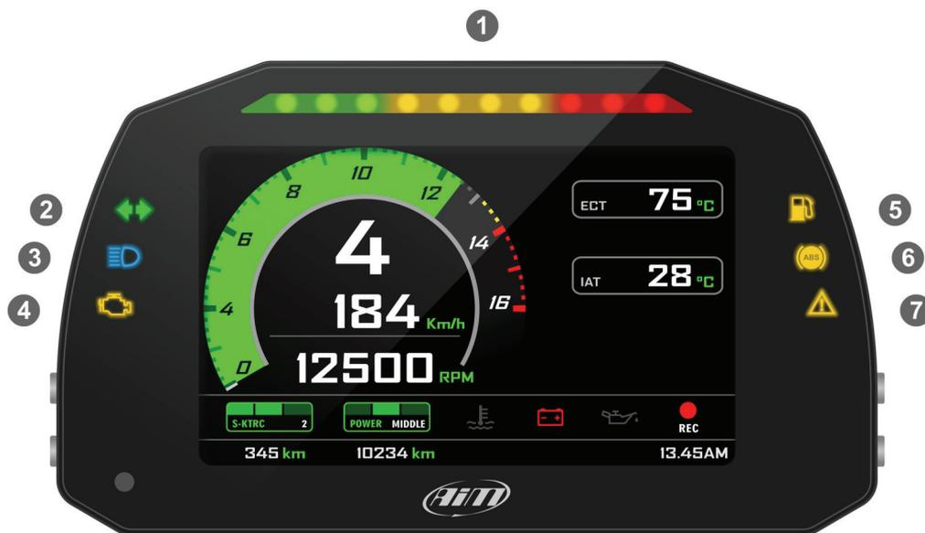
Sulla parte superiore del dash logger ci sono 10 LED per il cambio marcia personalizzabili (1): quando tutte le luci sono accese si suggerisce di cambiare marcia.
