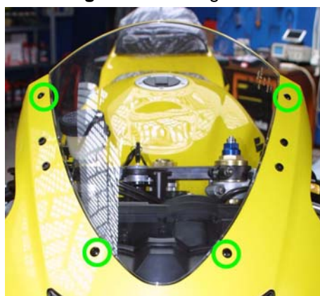
Figura 3: cupolino – 4 viti Phillips autofilettanti.
