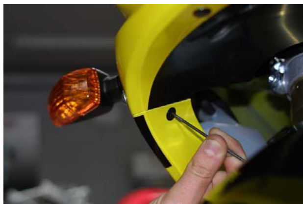
Figura 6: sbloccare la clip centrale della spina di plastica.
