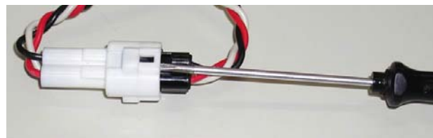
Figura 20: come sganciare un connettore.
