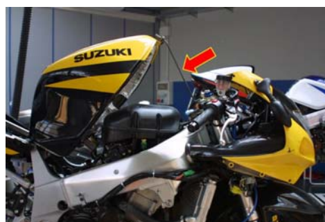
Figura 11: sollevare il serbatoio
