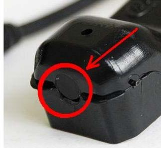
S'assurer que le récepteur ait une ligne continue avec l'émetteur du côté juste du véhicule.
