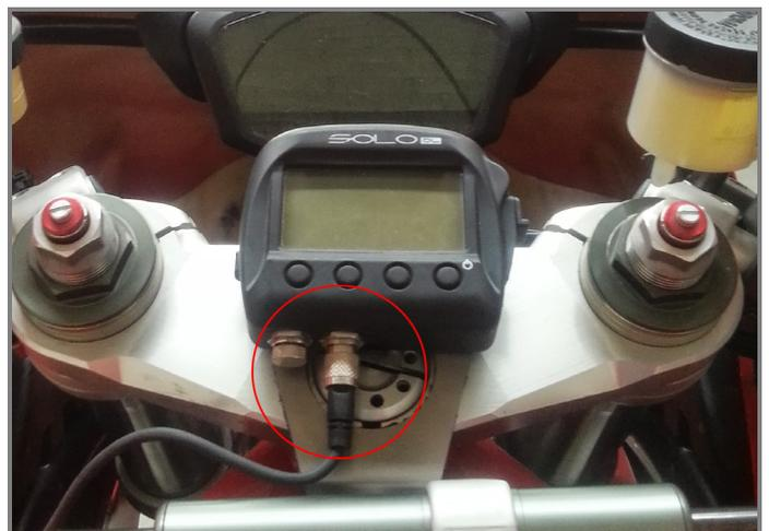
Per collegare SoloDL al cavo **V02569170** usate il Binder 712 – 7 pin femmina posto sotto a destra dello strumento come mostrato nello schema.
