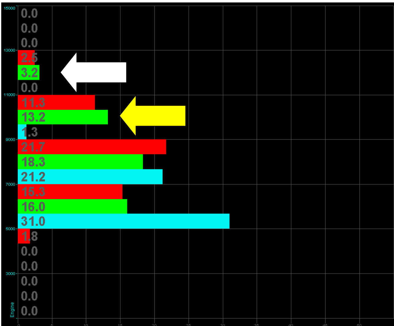
Figura 7: confronto tempi dei regimi RPM dei tre piloti Race Studio Analysis – finestra Istogrammi
