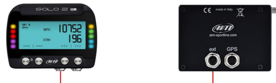
Per collegare Solo 2 DL a SmartyCam GP HD si usi il cavo CAN di SmartyCam: collegarlo al connettore Binder a 5 pin in basso a sinistra di Solo 2 DL e al connettore Binder a 7 pin di SmartyCam HD come mostrato sotto.
