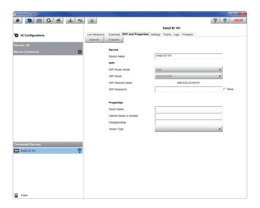
Questo AP o nome SSID è unico per il vostro strumento. Un esempio di nome è:" AiM-Solo2-00101" dove:
