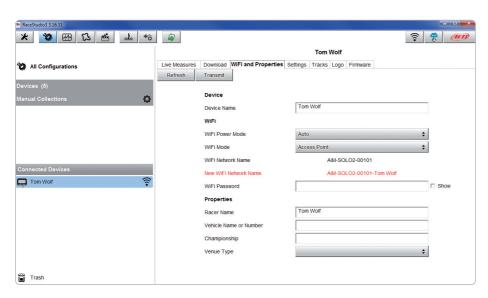
**Nota:** è possibile creare il collegamento Wi-Fi con l'applicativo del sistema operativo. Quando il sistema è stato autenticato nella rete Wi-Fi potete comunicarvi con il software Race Studio 3.
