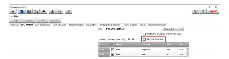
La disattivazione della modalità (impostazione di default) comporta la gestione del Bit di Acknowledge, che segnala la presenza di errori (NACK) o l'assenza di anomalie (ACK). Spuntando la casellina apposita, il sistema si pone in modalità Silent, non gestendo il byte descritto sopra.
